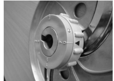
Die Reib- und Streifenscheiben werden mit dem Ausziehgriff ( bei G 24 K enthalten ) ebenfalls durch Linksdrehung von der Antriebsnabe abgezogen. Der Wechsel der Reib- oder Schneidscheibe darf nur bei ausgeschaltetem Antrieb vorgenommen werden!
