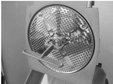
**Der Einfüllschacht oder der Rettich- und Gurkensneider darf sich niemals vom Schneidgehäuse nach vorne abheben lassen.**
