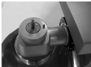
Auf dem Winkelgetriebe befinden sich 2 Bolzen. Diese dienen der sichern Aufnahme der Haube.
