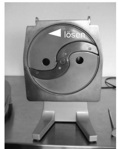
Die Schnittstärkenverstellung darf nur bei demontierter Scheibe vorgenommen werden!
