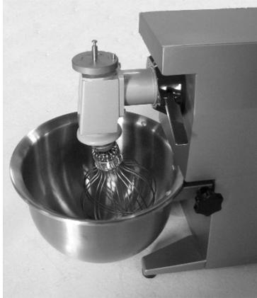
Auf dem Winkelgetriebe befinden sich 2 Bolzen. Diese dienen der sichern Aufnahme der Haube.
