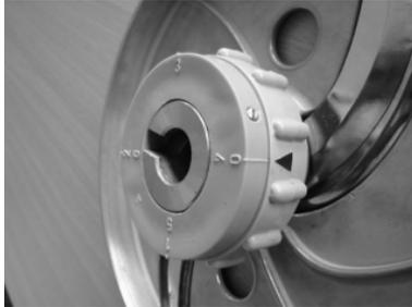
Die Reib- und Streifenscheiben werden mit dem Ausziehgriff ( bei G 26 K enthalten ) ebenfalls durch Linksdrehung von der Antriebsnabe abgezogen. Der Wechsel der Reib- oder Schneidscheibe darf nur bei ausgeschaltetem Antrieb vorgenommen werden!
