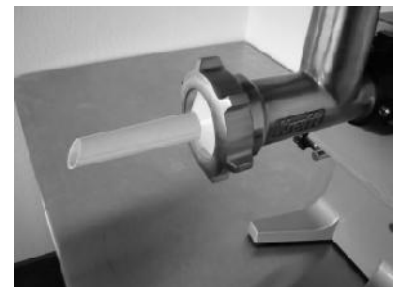
W 60 N mit angebautem Wurststopfer
