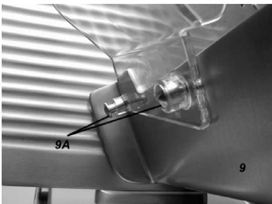
Setzen Sie den Fingerschutz außen an den Schiebeteller 9 an. Führen Sie die Gewindehülsen 9A durch den Fingerschutz und schrauben Sie diese fest, jedoch nicht zu fest, da sonst der Fingerschutz reißen kann.
